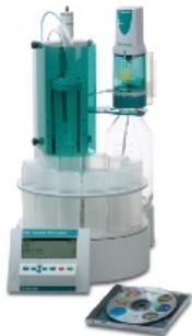
862 Food/Beverage Compact Titrosampler - это готовый комплект для потенциометрического анализа пищевых продуктов и напитков со встроенным автоподатчиком. Комплект включает в себя 862 Compact Titrosampler (потенциометрический титратор с автоподатчиком в одном приборе), а также все необходимые комплектующие:
